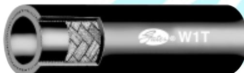
**Aplicação:** Em circuitos hidráulicos com pressões estáticas (Jack Hose). Não recomendada para sistemas dinâmicos com golpes de ariete (picos de pressões). Resistente ao óleo hidráulico a base de petróleo, óleos lubrificantes e água. Utilizada em máquinas lava jato comerciais profissionais e residenciais existentes no mercado.
